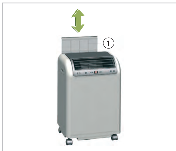
Fig. 20: Dépose du filtre
